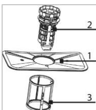
Трехкомпонентная система фильтрации предотвращает попадание больших объемов пищи или других предметов внутрь насоса.
