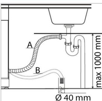
Подсоедините сливной шланг к сливной трубе (B) диаметром не менее 40 мм; в качестве альтернативы сливной шланг можно закрепить непосредственно на раковине (A).
