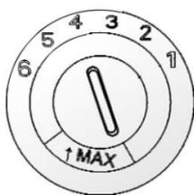
Диспенсер ополаскивателя имеет 6 уровней расхода. Начните с 4 уровня. Если после высыхания видны пятна и полосы от подтеков повысьте уровень расхода. Для этого откройте крышку дозатора и поверните ручку регулировки на один уровень выше.
