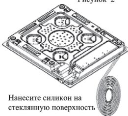
Нанесите силикон на стеклянную поверхность.
