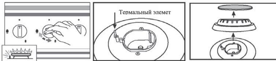
Устройство безопасности отключения газа
